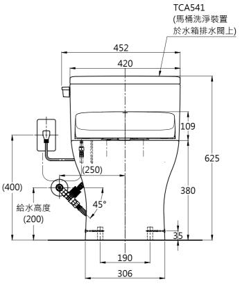
※為防止軟管折彎,止水栓適當安裝角度如圖向下45°
