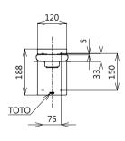
包裝內含前方扶手(上掀活動式)用M10的六角螺帽、彈簧墊圈、平墊圈 安裝前方扶手時(上掀活動式)時,請務必使用本公司所指定的固定金具,進行施工 前方扶手(上掀活動式),支撐板顏色:棕色(#SY) 前分扶手(上掀活動式),外蓋顏色:白色(#NW1)
