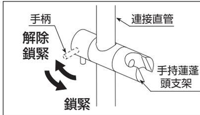
將手柄調整到“解除鎖緊”位置，可上下滑動手持蓮蓬頭支架，選定理想高度後，將手柄調整到“鎖緊”位置即可。
