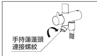
圖示中的連接彎頭可360°旋轉，使用過程中客戶可根據需要自行調節彎頭方向。
