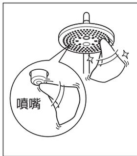
若使用時出現水線不均勻的現象，可用毛巾輕輕擦拭花灑頭上的小橡膠吐水口，清除異物。
