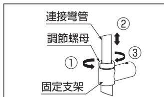
① 逆時針鬆開調節螺母至連接彎管可上下移動的程度。
