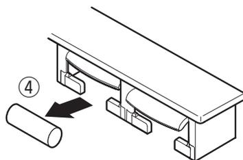
※請使用衛生紙芯內徑38mm、直徑120mm以下、寬度105~114mm的衛生紙。
