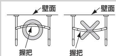
依右圖順序，螺栓穿過彈簧墊圈，使用六角扳手暫時固定握把。
