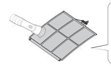
無法清除乾淨時 請將濾網放入溶解中性清潔劑的溫水中。 使用海綿等柔軟物將污垢清除乾淨。 請用清水沖洗 請用抹布擦拭後晾乾。
