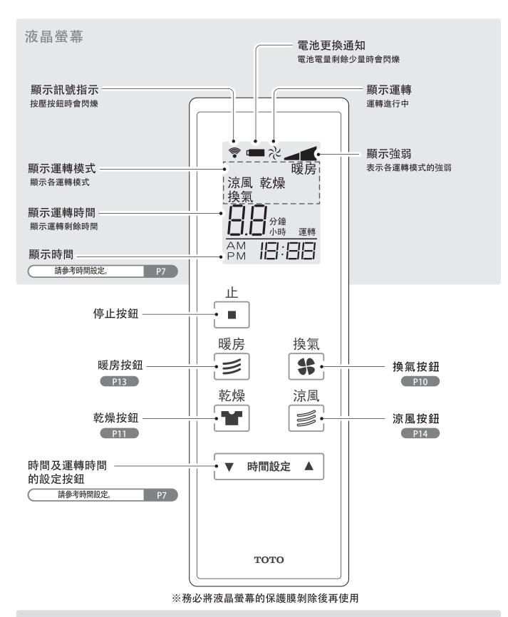
建議 在運轉中操作其他運轉按鈕時機器內部為了運轉切換的準備,大約需要10秒~40秒的切換時間。 在運轉中操作同樣的運轉按鈕(模式切換)時運轉的剩餘時間被復位,恢復到各模式設定的時間。
