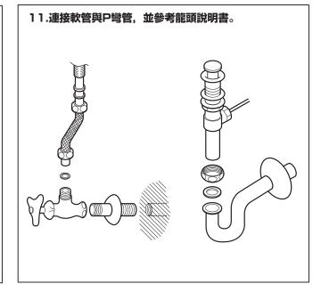
注意: P彎管及牆壁的排水孔連接要牢固,並使用矽利康 避免漏水等不良狀況產生。
