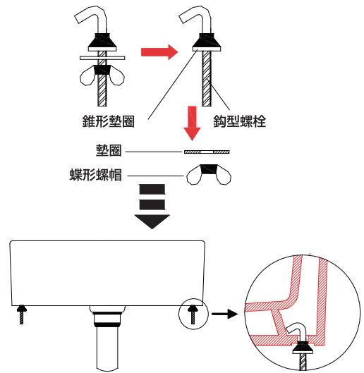
4. 將洗手盆放上檯面，以翼型螺帽固定洗手盆。
