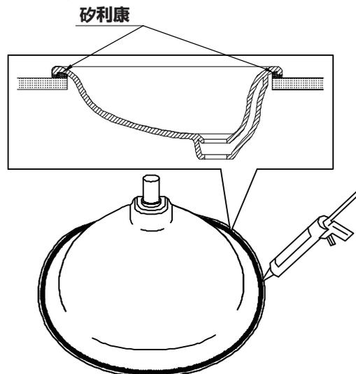
6. 安裝臉盆至檯面上。注意：把臉盆放至檯面上後，將臉盆調整至正確位置，並確認其底部能遮蔽檯面切口。
