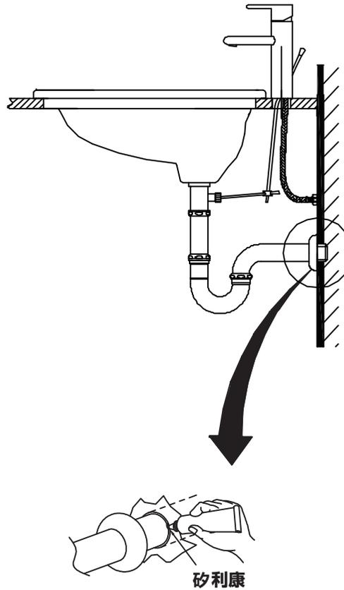
注意：P彎管及牆壁的排水孔連接要牢固，並使用矽利康避免漏水等不良狀況產生。
