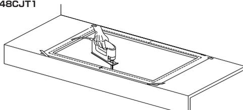
3. 將固定金具插入金具安裝孔後，將臉盆放上檯面。
