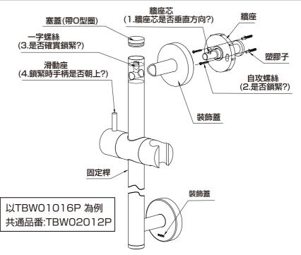
安裝後萬一出現故障,請按照以下方法拆卸。(此圖內未拆解的零件,需要拆卸的情況下.請聯絡售後服務人員進行拆卸)
