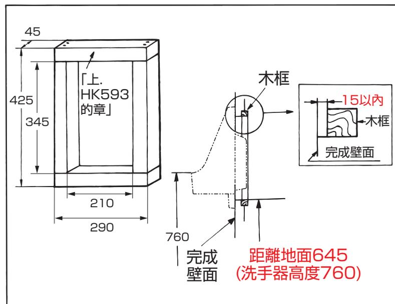
・請避免弄錯方向，依上圖所示，在壁面完成前，將木框固定在牆壁。
