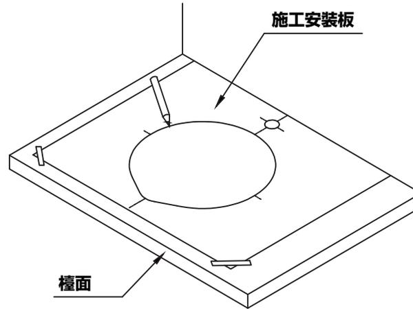
3. 取下施工安裝板後，將檯面切開及鑽孔。
