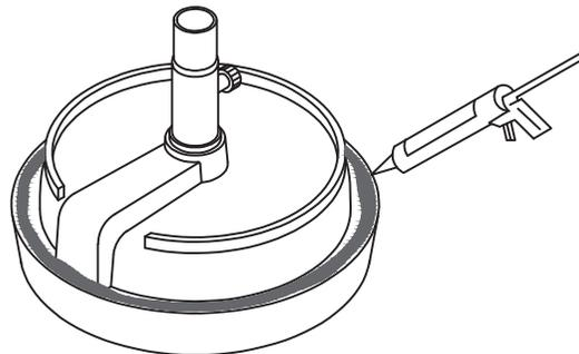
6. 安裝臉盆至檯面上。注意：把臉盆放至檯面上後，將臉盆調整至正確位置，並確認其底部能遮蔽檯面切口。
