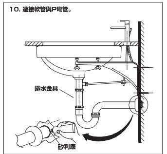
注意: P彎管及牆壁的排水孔連接要牢固, 並使用砂利康避免漏水等不良狀況產生。
