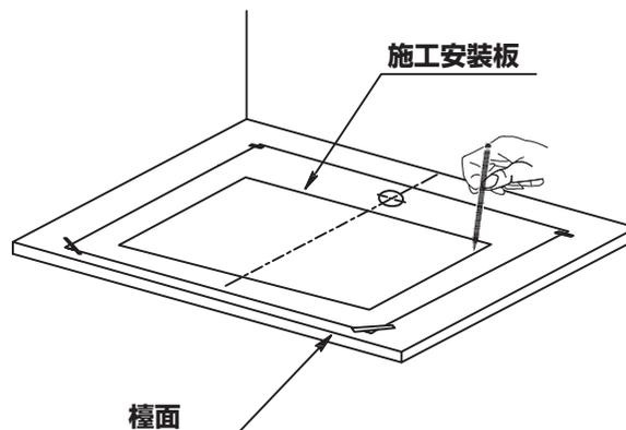
3. 取下施工安裝板後，將檯面切開及鑽孔。
