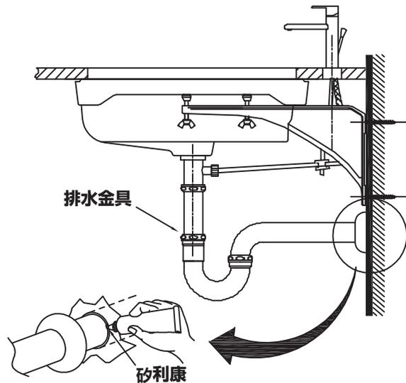
注意: P彎管及牆壁的排水孔連接要牢固，並使用矽利康避免漏水等不良狀況產生。
