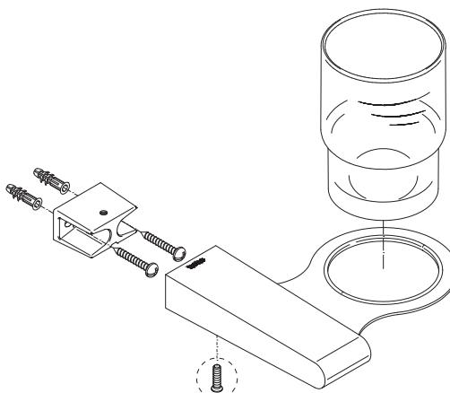
**注 意****◆ 不可安裝於輕質混凝土及白磚牆等壁面****◆ 安裝後的確認**為避免發生掉落、搖晃等情形發生,安裝時,
