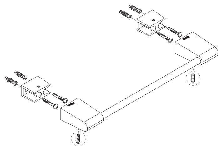
**注 意****◆ 不可安裝於輕質混凝土及白磚牆等壁面****◆ 安裝後的確認**
