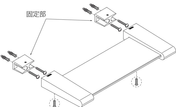
※固定螺絲請勿使用電動工具鎖付，以免造成螺牙崩壞。
